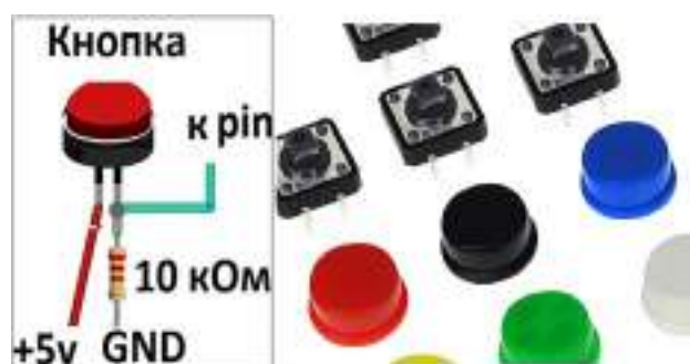
Рис. 1. Схема подключения тактовой кнопки к микроконтроллерной плате
